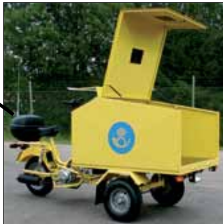
Den låsbara luckan hålls i öppet läge av två gasfjädrar.
