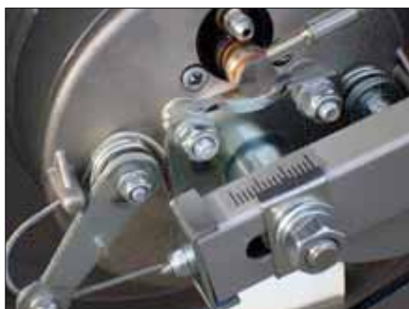
Kontroll av rätt kedjespänning sker genom att först trycka ned kedjan....
