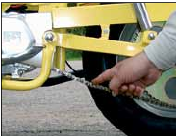
Kontroll av rätt kedjespänning sker genom att först trycka ned kedjan....
