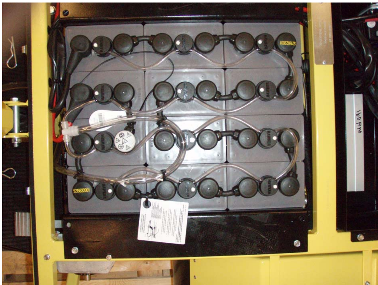
Bilden visar ett 160 Ah batteripaket med centralpåfyllning.
